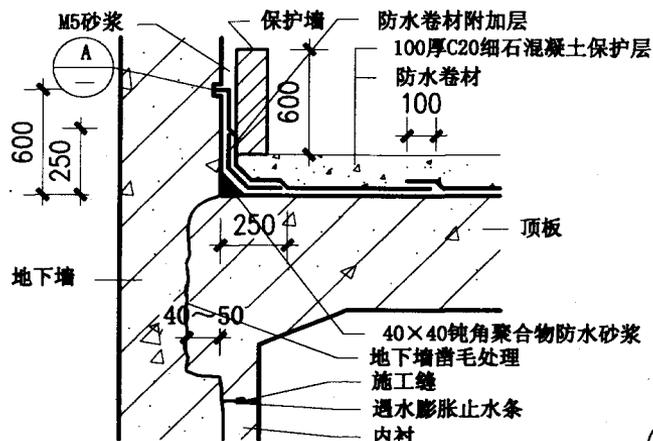
① 有内衬时顶板与地下墙 T型接头
