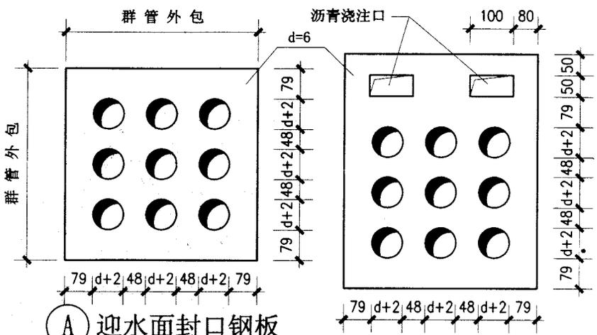
(A) 迎水面封口钢板 (B) 背水面封口钢板
