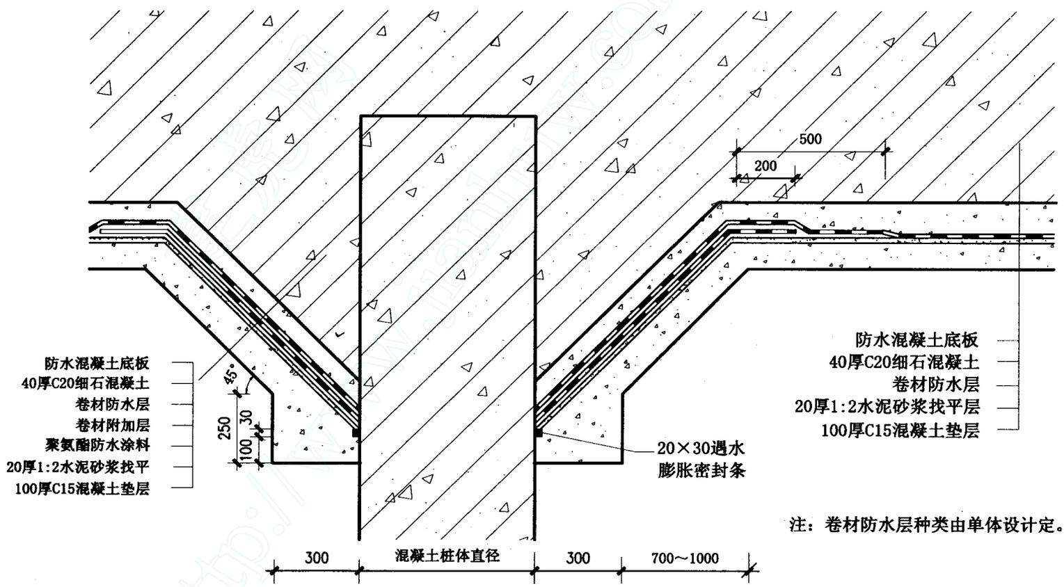
防水混凝土底板
