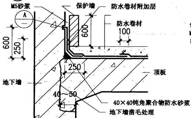
③ 无内衬时顶板与地下墙 T型接头
