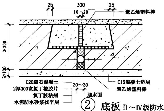
粘贴式变形缝防水构造
