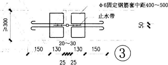
中埋式止水带变形缝防水构造
